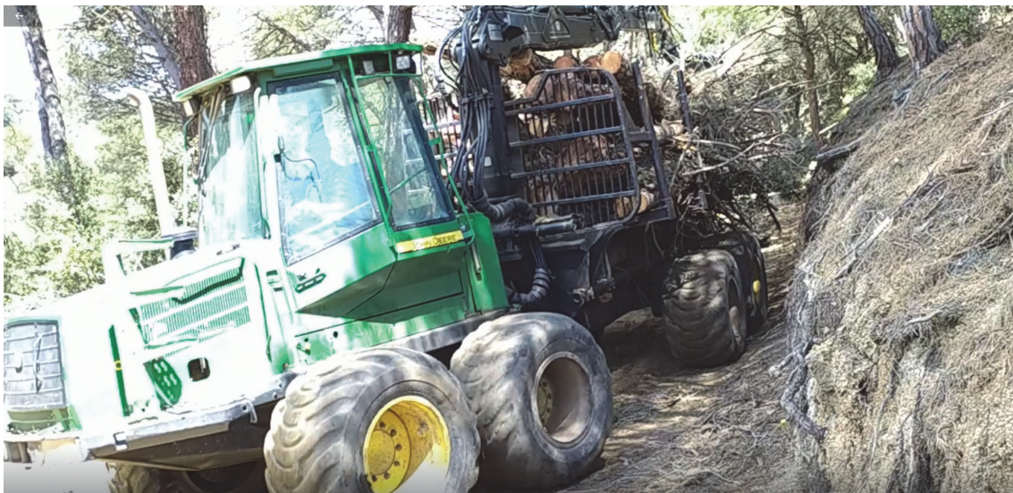
Figura 34. Transporte mediante autocargador.
