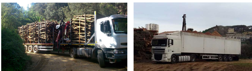
Figura 37. Tráiler con o sin contenedor para el transporte de madera o astilla.
