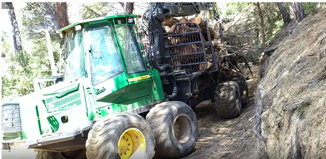
Figura 34. Transporte mediante autocargador.
