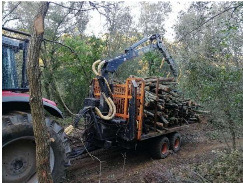
Figura 32. Desembosque con remolque acoplado a un tractor forestal.
