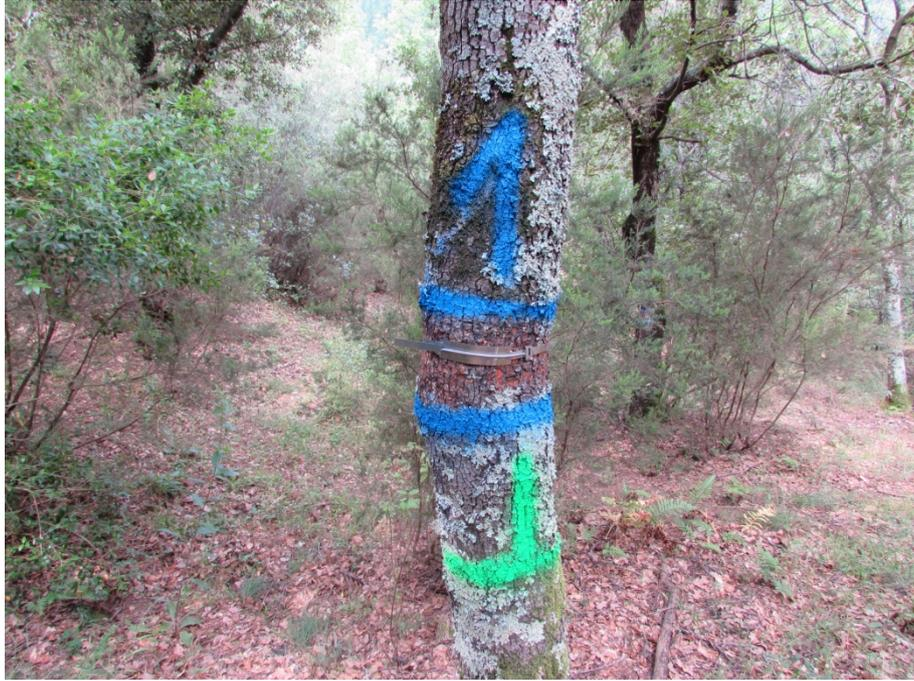
Árbol "T" con dendrómetro instalado
