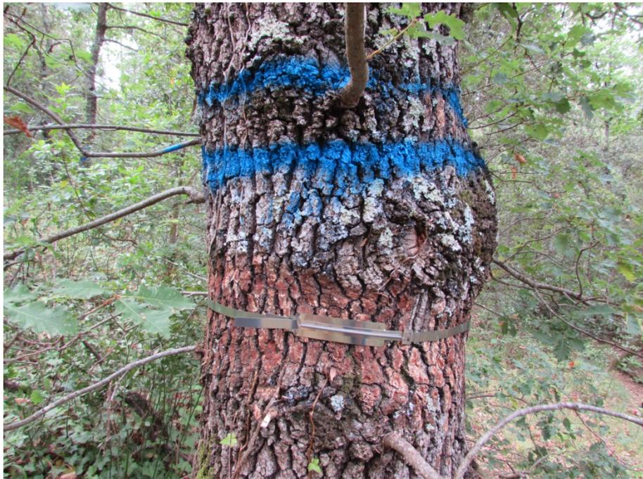
Detalle de un dendrómetro
